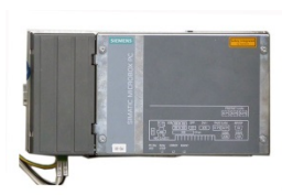
Bild 3-2) Optionaler Industrie-Computer (IPC, Bild zeigt Typ EQ2692-...) nur im großen Schaltschrank Typ AC-2161
