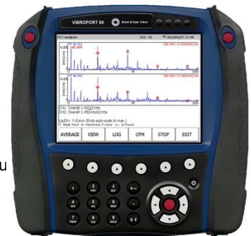
Screenshot einer 2-Kanalmessung FFT
