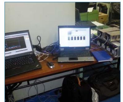
Abb. 1: Konfiguration des Überwachungssystems für den Test des Maschinenstranges in der Testanlage des Lieferanten
