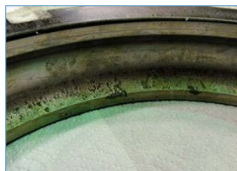
Abb. 1: Die Maschine kann, unabhängig von der zugrunde liegenden Ursache, nicht immer umgehend heruntergefahren werden, sobald ein Schaden festgestellt wird. Daher steht bei beschädigten Lagern ein Lagerversagen oft kurz bevor (siehe Abbildungen oben).
