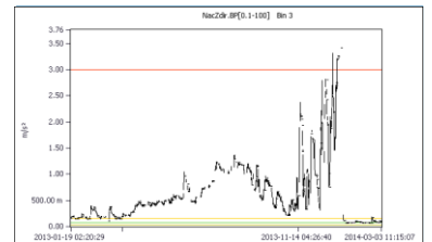
Abb. 2: Der niederfrequente Bandpass-Schwingungstrend in Abwindrichtung deutet auf lose Federn in der Azimutbaugruppe hin.
