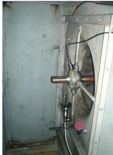
Abbildung 1 Antriebsseite (links) und Nichtantriebsseite (rechts) des Klimaanlagegebläses mit Aufbau des Referenzsensors
