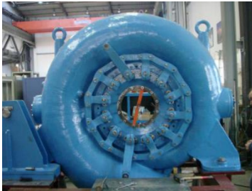
Abbildung 1 Der Betrieb von Andritz Hydro in Schio, Italien. (Das Spiralgehäuse und der Verteiler im Bild gehören zu einigen älteren Generatoren, die überholt und durch eine gemeinnützige Organisation in südamerikanischen Kleinstädten wieder aufgebaut werden. Zu diesem Zweck hat man Mitarbeiter von Andritz Hydro, die bereits in Rente sind, gebeten, zur Wiederherstellung und Inbetriebnahme dieser Generatoren in Teilzeit in das Unternehmen zurückzukehren.)
