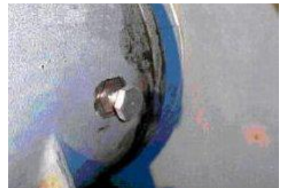
Abbildung 3 Typische Position eines Beschleunigungssensors für die Überwachung von Stoß- und Gehäusevibrationen Installation innerhalb kürzester Zeit
