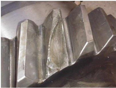
Abbildung 6 Beschädigter Zahnabschnitt des Zahnradgetriebes
