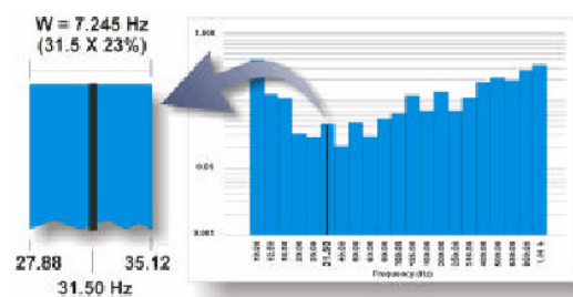
Bild 2: Eine 23%-CPB-Messung von 10 bis 1000 Hz hat 21 Frequenzbänder. In diesem Beispiel hat jedes Band eine Bandbreite, die 23 % der Mittenfrequenz beträgt.
